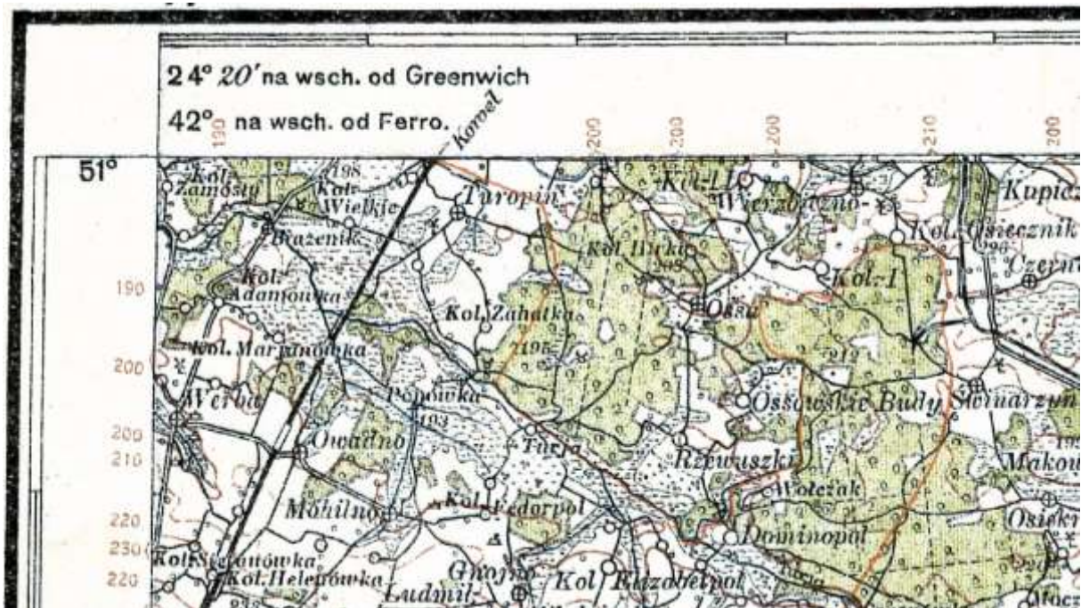
Рис 2.1. Фрагмент аркуша “Луцьк” загальногеографічної карти ВІГ масштабу 1:300 000 (в оригіналі) із зазначенням двох вихідних меридіанів (Ферро та Грінвіцького), видання 1928 року [137].
