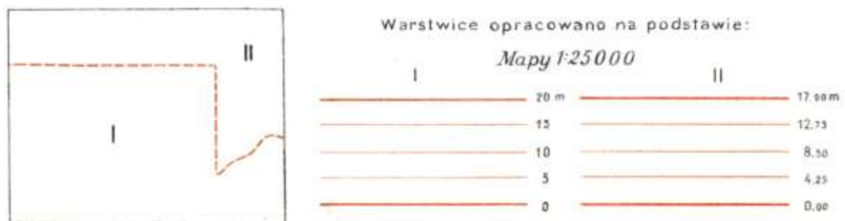
Рис. 2.2. Розподіл аркуша карти масштабу 1:100 000 на зони відповідно до різних значень висоти перерізу рельєфу.
