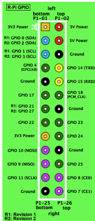
Рис.7.1 Позначення виводів GPIO
