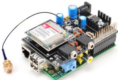
Рис.10.29 Плата розширення з модулем SIM9XX на Raspberry Pi
