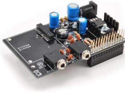
Рис.10.28 Плата розширення без модуля SIM9XX
