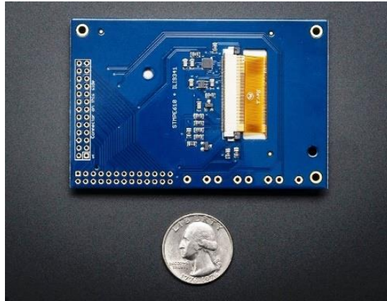
Рис.10.2 Зворотна сторона сенсорного екрану
