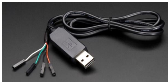
Рис.8.16 Послідовний кабель USB до TTL
