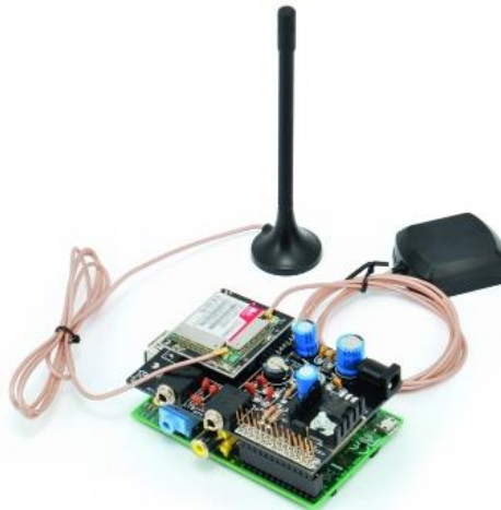
Рис.10.25 Використання плати з SIM 908 на Raspberry Pi
