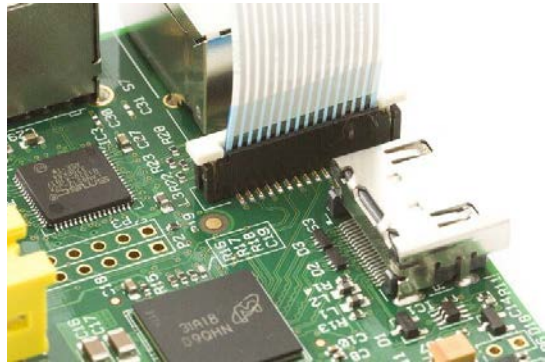
Рис.4.2 Під'єднання гнучкого кабелю камери
